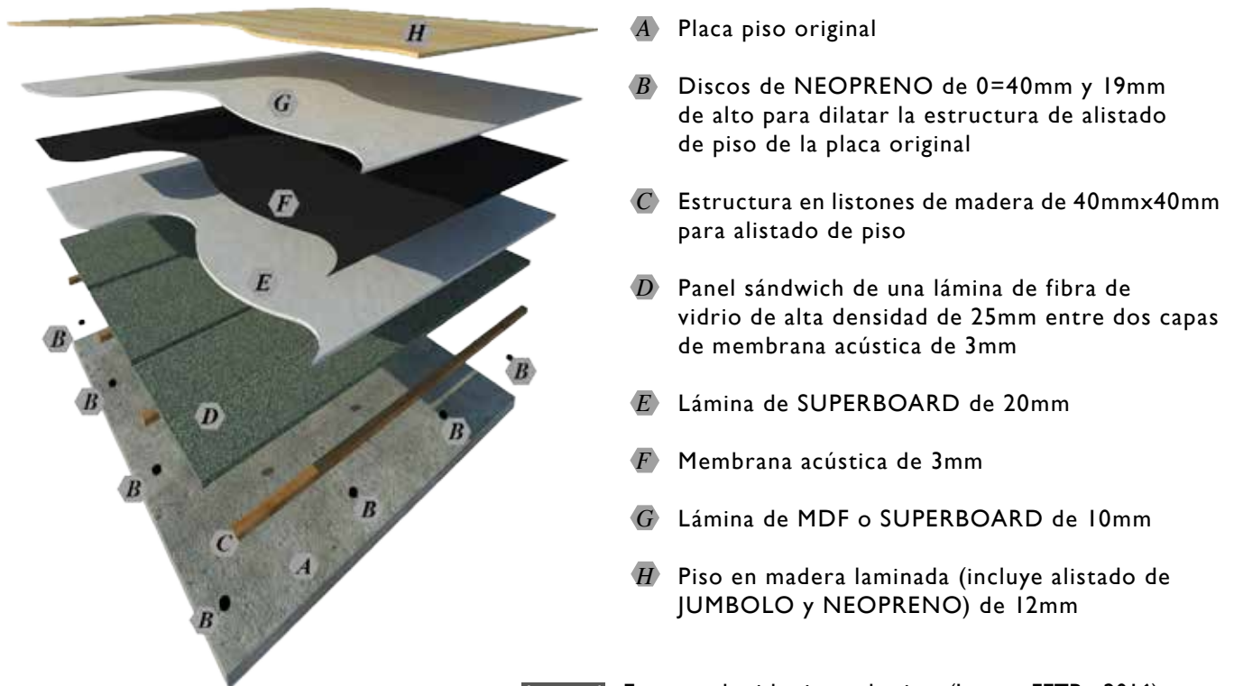
Imagen 1 Esquema de aislamiento de pisos (Imagen FETB - 2016)
